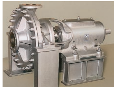
RCE-Pumpe mit Mittenaufhängung, kühlbarem Lagerbock und Dichtungseinsatz zur Förderung von flüssigem Kunststoff (420 °C) RCE pump with central isolation, cooled bearing pedestal and seal insert for pumping liquid plastic (420 °C) Pompe RCE avec support de volute au niveau de l'axe, chaise de palier et flasque de garniture refroidis pour le pompage de matière plastique (420 °C).
