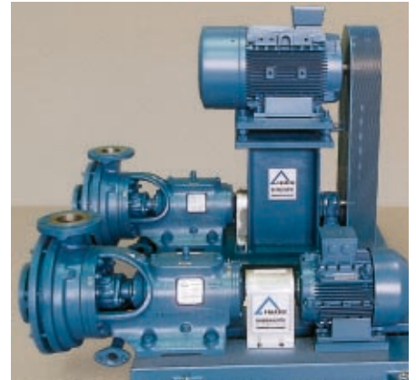
RCE 80/260 DW für die KTL-Lackieranlage eines großen Automobilwerkes. RCE 80/260 DW pump for cathophoretic paint in a large car factory. RCE 80/260 DW en service dans l'installation de peinture cataphorèse d'une importante usine de construction automobile.
