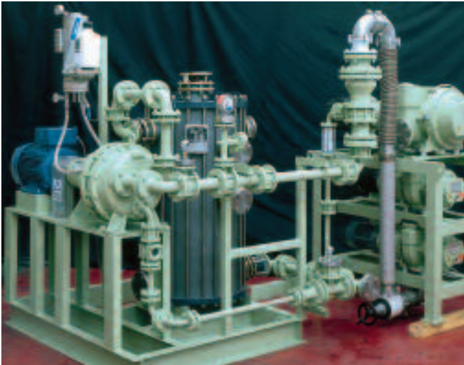
Vakuumpumpanlage für abs. Drücke bis 2 mbar (A) bestehend aus einer dreistufigen Wälzkolbenpumpenkomination und einer nachgeschalteten Flüssigkeitsring-Vakuumpumpe Typ FGP. Die Anlage wird in einem kontinuierlichen Verdampfungsprozess eingesetzt wo HCl-haltige Dämpfe abgesaugt werden.
