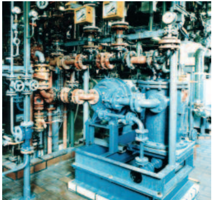
Gaspumpen-Kompaktanlage Typ FGP aus Keramik / PTFE / Hastelloy zur Verdichtung korrosiver Gase vor der Verbrennungsanlage
